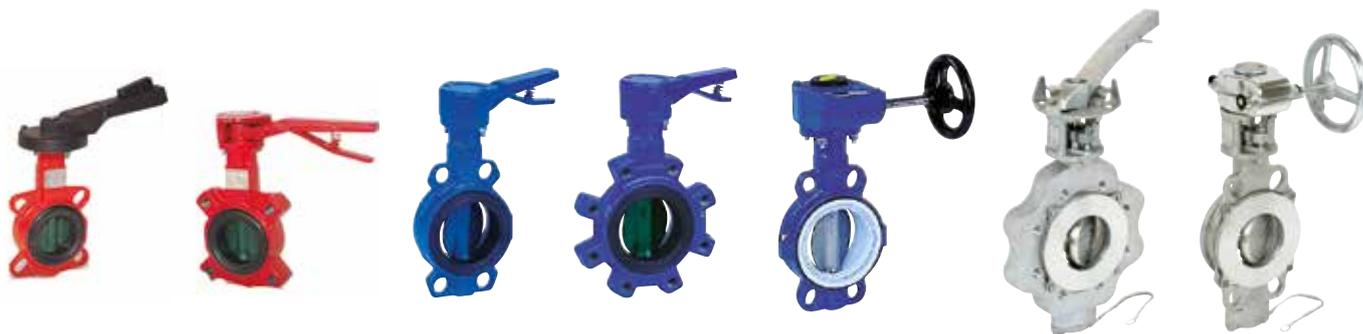
Vannes papillon fonte Polyamide, époxy, cupro alu ou inox. Manchette EPDM, Nitrile, Viton, Hypalon ou silicone. Revêtements PFA et PTFE de forte épaisseur. Vannes à double excentration et joints PTFE chargés pour applications jusqu'à 50 bar et -50°C à +200°C.
