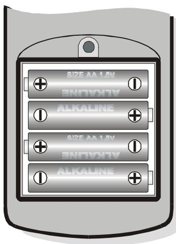
**Après le changement de piles, il faut régler de nouveau la date, l'heure, le baud rate, le type de sonde, l'intervalle d'impression, les paramètres de logging: pour simplifier l'opération, lors de l'insertion des nouvelles piles, l'instrument s'allume automatiquement et demande ensuite**
