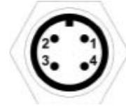
(\*) Le câble 5 pôles CPM12-5 est compatible avec le connecteur 4 pôles du transmetteur. Le fil gris est connecté à la broche 5 (centrale) du connecteur femelle du câble et n'est pas utilisé par le transmetteur.
