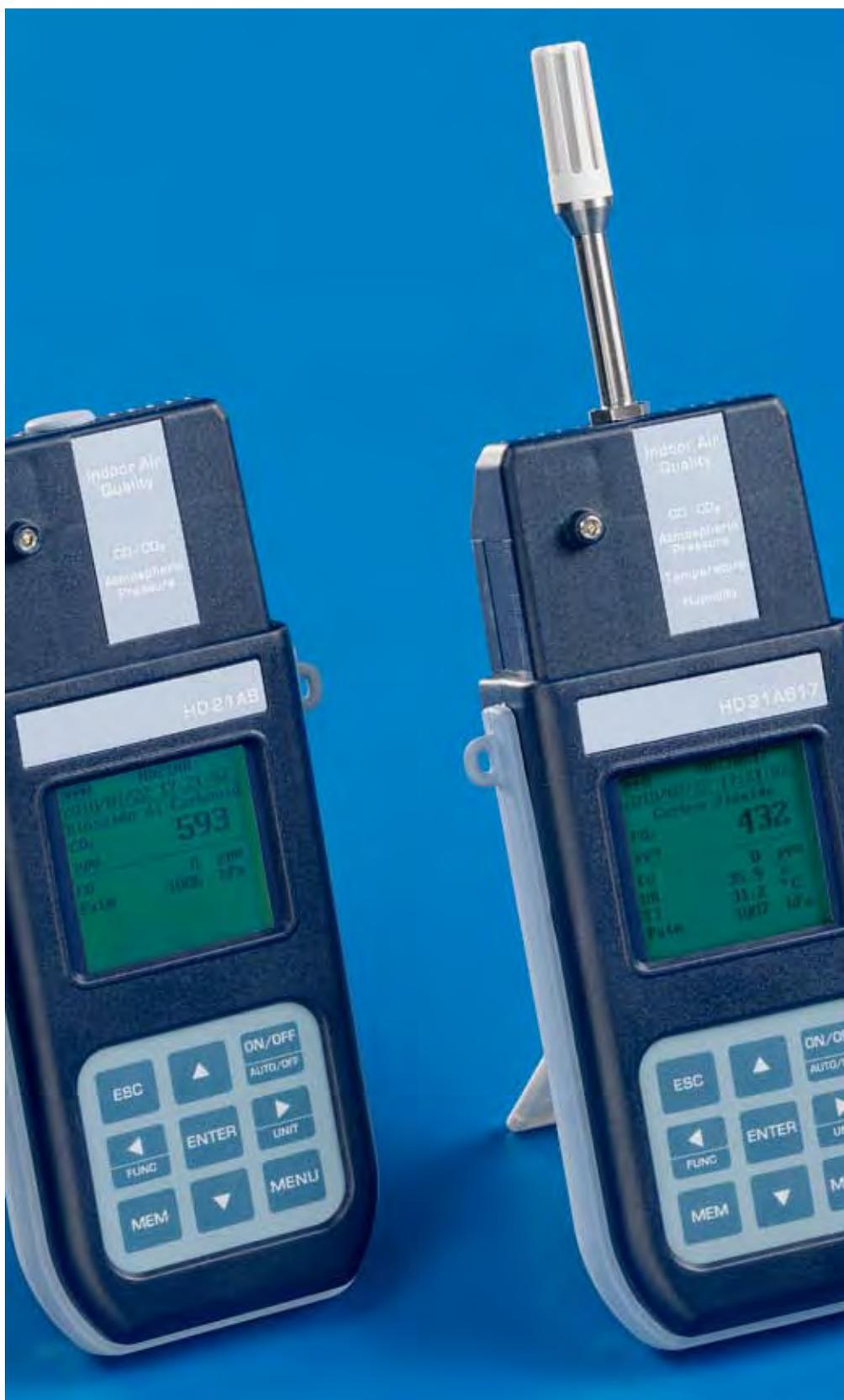
**HD21AB** et **HD21AB17** IAQ Monitor sont des instruments de paillasse/portatifs produits pour l'analyse de la qualité de l'air (Indoor Air Quality, désigné par le sigle IAQ), dans un environnement intérieur.
