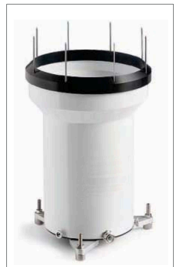
Pluviometre avec dispositif anti-oiseaux.
