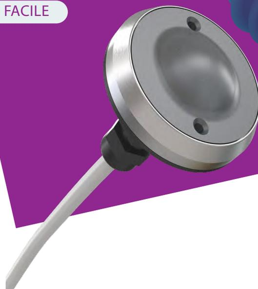
Sonde d'humidité relative et de température encastrable pour salles blanches : **0 à 100 %RH, -20 à 80 °C (-4 à 176 °F)**. Corps en inox et filtre fritté.
